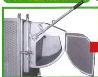
投入機に焼却物を投入
